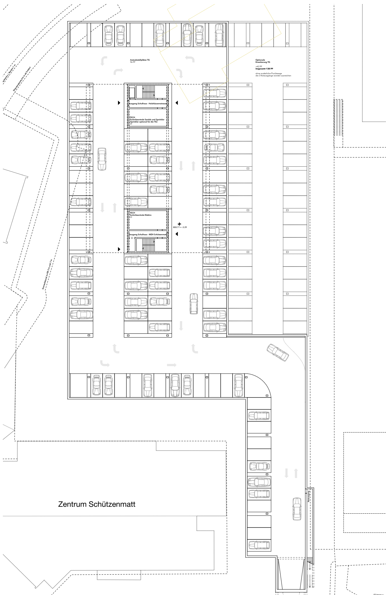
Grundrisse Einstellhalle, Siegprojekt Neubau Ochsenmatt 4
